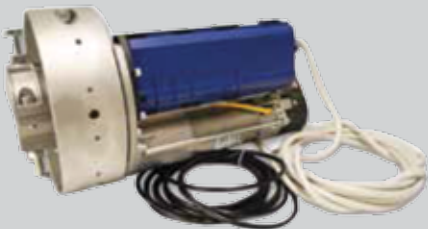
Motore coassiale per albero a molle 220 V o 24 V avente coppia di impiego da 155 Nm a 450 Nm, grado di protezione IP 20.
