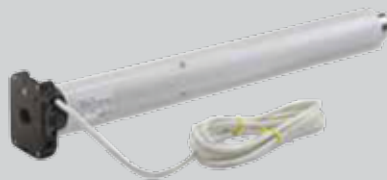
Motore tubolare a 220 V o 24 V avente coppia di impiego da 30 Nm a 100 Nm, grado di protezione IP 44.
