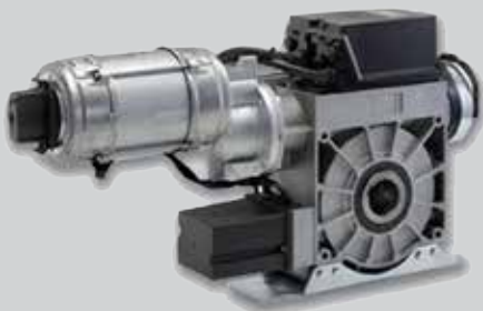
Motore laterale 380V tipo SI avente coppie di impiego da 750 Nm a 1800 Nm, dispone della certificazione TUV, grado di protezione IP 54.
